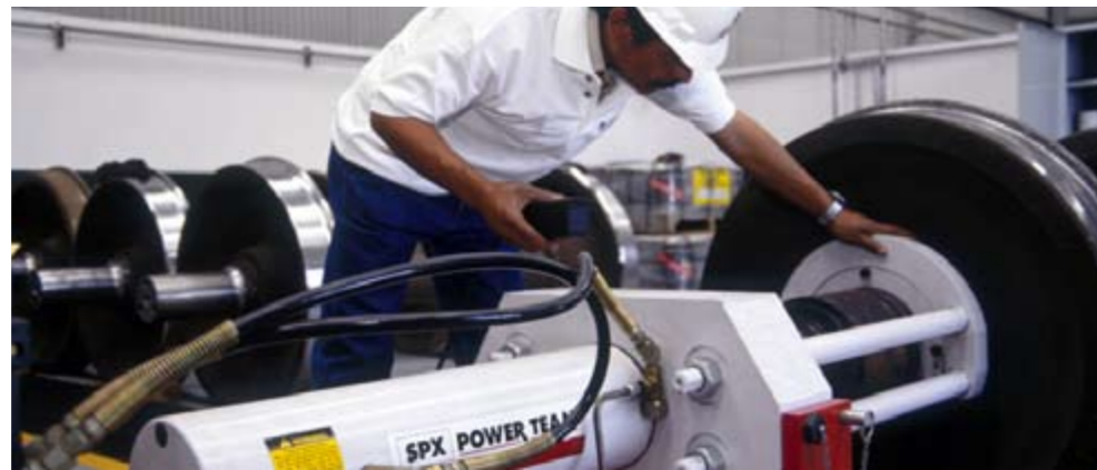
Taller de torno de ruedas/extractor de baleros de mancuerna con capacidad de 100 toneladas de presión.
